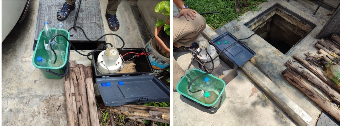
จุดเก็บตัวอย่างน้ำที่บ่อตรวจคุณภาพน้ำทิ้ง โดย Sampling Pump
